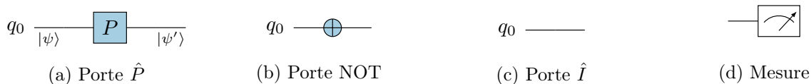
FIGURE 1.5 – Diagrammes représentant différentes portes quantiques à un qubit (a-c) ainsi que la mesure (d). Ces représentations seront utilisées pour construire des circuits quantiques.
